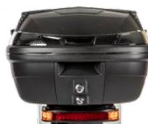
Coffre supérieur équipé de serrure électronique contrôlée par télémétrie, avec capteur de serrure et capteurs pour vérifier présence de casques.
